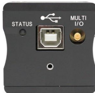
Photo 2.1 Connecteur USB et voyant d'état
