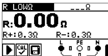
Schéma 5.10 : Exemple de résultat RLOW
