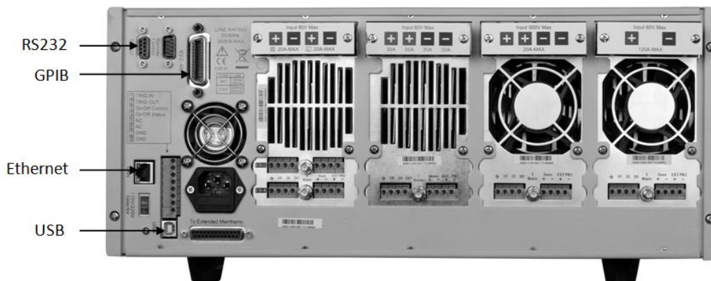
Schéma 32 – Interface de communication de la face arrière de l'unité centrale
