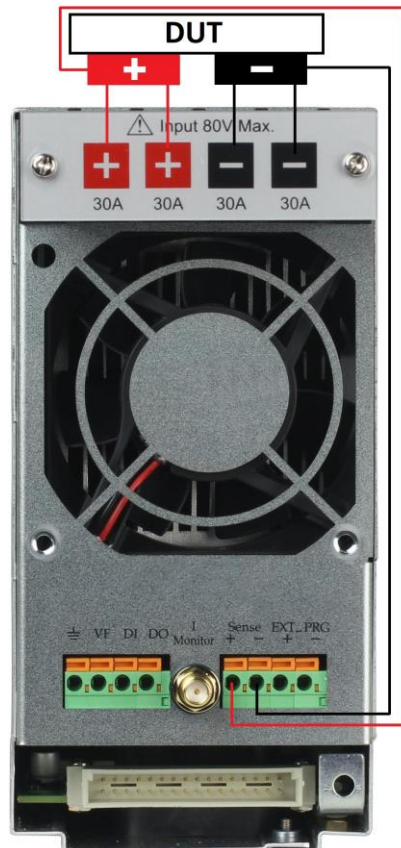
Schéma 9 – Connexion de la charge et de l'appareil sous test (DUT)
