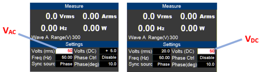
Image 13 : Régler la tension ( V_{AC} à gauche, V_{DC} à droite)
