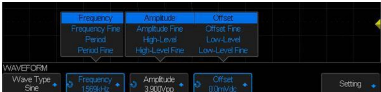
Image 133 – Paramètres de formes d'ondes
