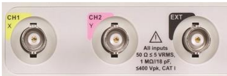
Image 15 – Connecteurs analogiques et de déclenchement externe
