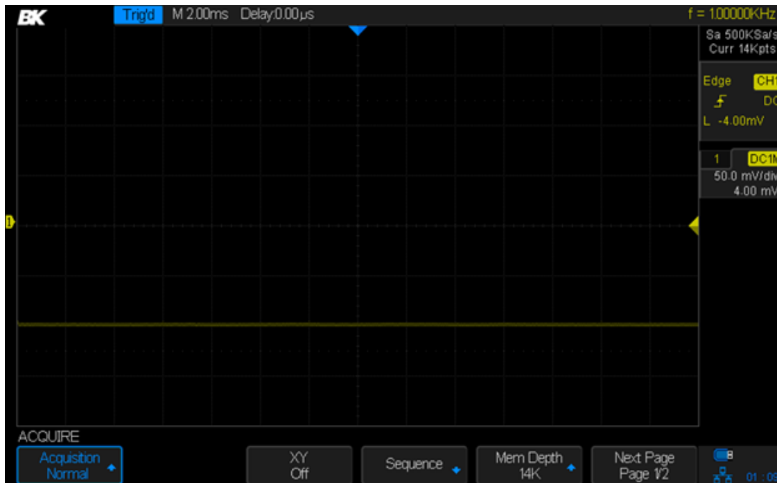
Image 34 - Impulsion avec un rapport cyclique de 0,1 %, mode normal
