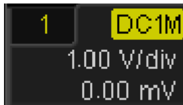
Image 6 – Affichage des paramètres de voie
