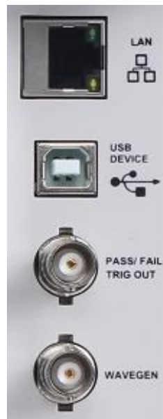
Image 18 – Connecteurs du panneau arrière
