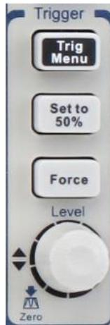
Schéma 3.20 – Contrôles Trigger
