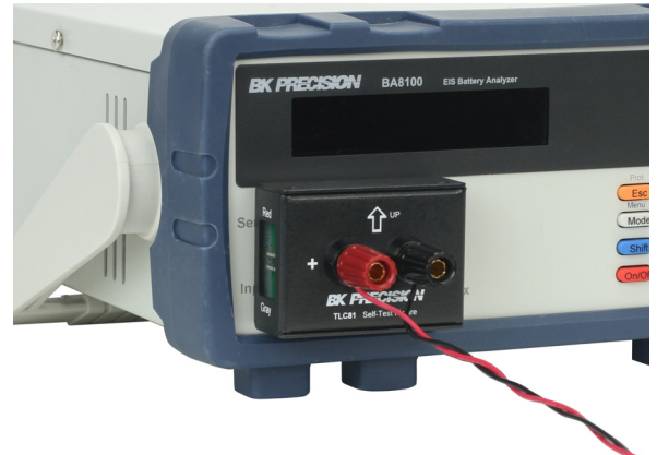
Connecté à une source DC externe de 5 V et 3 A
